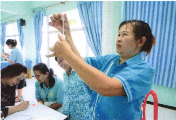
อสม. ผักติดดาว เติมหั่วทำละลาย ๑ ในผักที่หั่นละเอียด แล้ว เพื่อสกัดเอายาฆ่าแมลงจากตัวอย่างผักออกมาเข หากมีการปนเปื้อน
